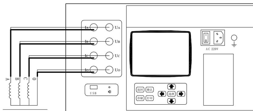
高压侧三相、单相、单线测试接线图
