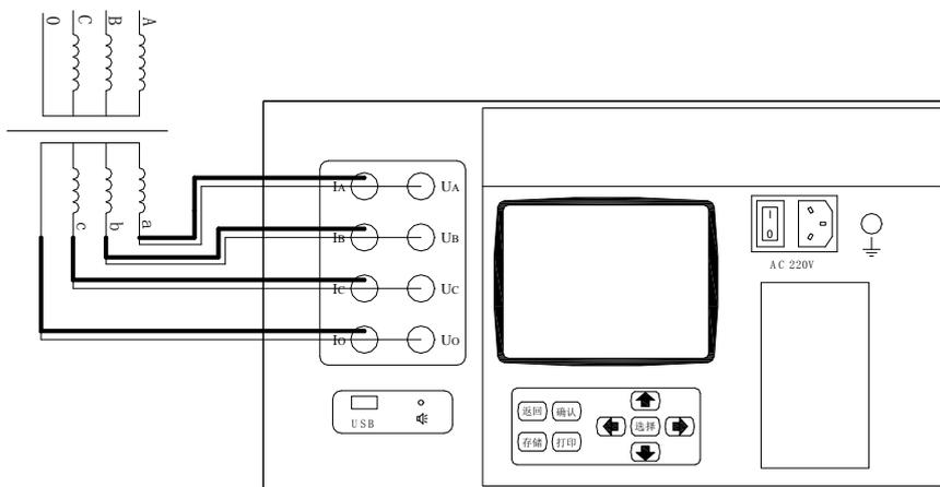
低压侧三相、单相、单线测试接线图
